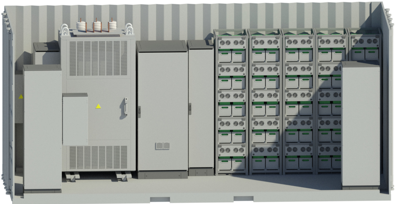
Рисунок 5 –3D-вид компоновки СНЭ-0,4-200/124-124 УХЛ11
